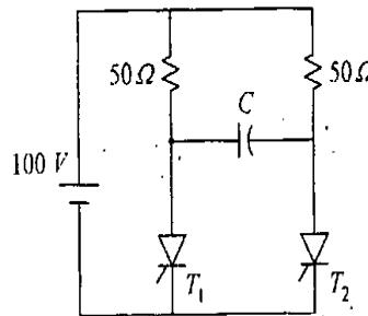
ऊपर चित्र में एक वोल्टता दिक्परिवर्तन परिपथ दिखाया गया है। SCR के लिये शमन काल 50 माइक्रो सैकेण्ड है। 2 की सुरक्षा छूट सम्मिलित की जानी है। उचित दिक्परिवर्तन के लिये संधारित का न्यूनतम मान क्या करना होगा?
